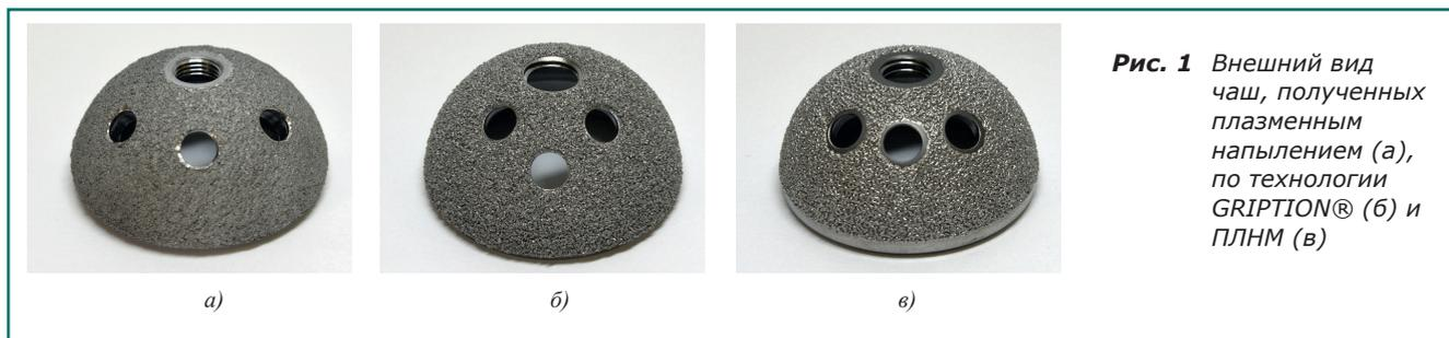
**Рис. 1** Внешний вид чаш, полученных плазменным напылением (а), по технологии GRIPTION® (б) и ПЛНМ (в)
